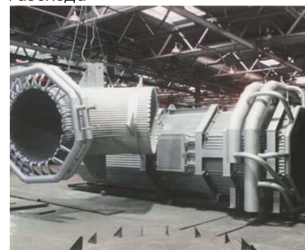
Секции водоохлаждаемого газохода
