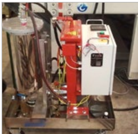
Электростатическая установка для очистки гидравлического масла
