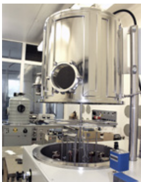
Установка VSE-PVD-Term для нанесения плоских и трехмерных контактов на полупроводниковые структуры
