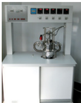
МOCVD установка для нанесения биологически совместимых наноструктурированных металлических (Ir, Pt) и композиционных (Ir-IrO 2 , Pt/Ir) покрытий
