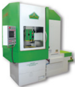
ЛШ600 — плоскошлифовальный станок с программным управлением
