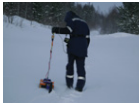
Георадарная съемка георадаром ОКО-2
