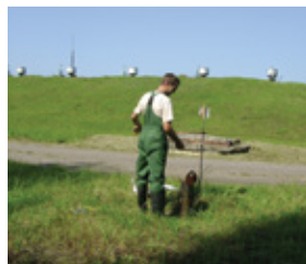
Отбор проб подземных вод из наблюдательной сваи
