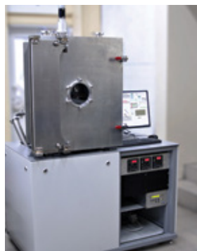
Установка для термического напыления материалов VSE-PVD-LTE для получения металлических и органических покрытий методом термического испарения
